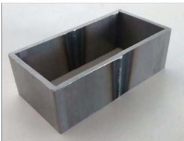
Geschlossenes Rechteckprofil als Referenzanwendung „Crashbox“
