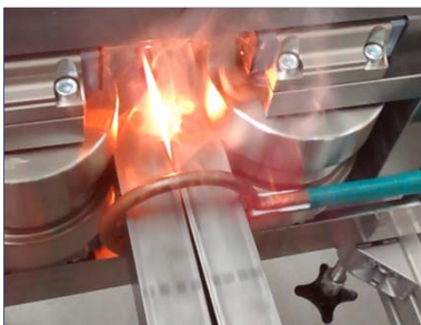
HFI-Längsnahtschweißen zweier U- Profile
